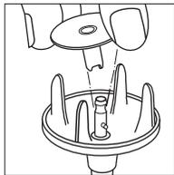
Inserire l'utensile il più verticalmente possibile sull'albero motore, di modo che l'intaglio possa agganciarsi perfettamente al perno di trascinamento dell'albero motore stesso. La corretta centratura facilita l'inserimento. La rimozione dell'utensile avviene tramite la semplice estrazione. Utilizzare un panno morbido per la protezione dei mani.
