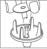
Stecken Sie das Arbeitsteil möglichst senkrecht auf die Welle, und zwar so, dass der Mitnehmerstift der Antriebswelle genau in die Kerbe des Arbeitsteils passt. Die Aufsteckzentrierung erleichtert das Aufstecken. Das Abnehmen des Arbeitsteils erfolgt durch einfaches Herausziehen. Zum Schutz der Finger können Sie dazu auch einen Lappen verwenden.
