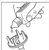
Il bamix durerà molto più a lungo se si provvederà ad oliarlo ogni due mesi. È opportuno utilizzare un olio non acido (per esempio olio di vaselina, comunemente reperibile in farmacia). Tenere il bamix con la calotta di protezione verso l'alto, depositare 2-3 gocce d'olio sull'albero motore e azionare l'apparecchio per circa 2-3 minuti. Quindi, lavare l'apparecchio in acqua calda.
