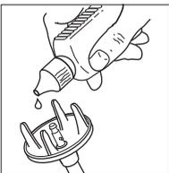
Der bamix bleibt länger «fit», wenn Sie ihn alle paar Monate ölen. Verwenden Sie dafür säurefreies Öl (z.B. Vaselineöl, das Sie in der Apotheke erhalten). Halten Sie den bamix mit der Schutzhaube nach oben, geben Sie 2–3 Tropfen Öl an die Antriebswelle und schalten Sie das Gerät ca. 2–3 Minuten lang ein. Reinigen Sie danach das Gerät im heissen Wasser.
