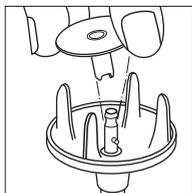
Insérez l'accessoire aussi verticalement que possible sur l'axe de manière que la goupille d'entraînement s'ajuste dans l'encoche de celui-ci. L'insertion est facilitée par le centrage. Pour retirer l'accessoire, il suffit de le tirer. Veillez à protéger vos doigts avec un chiffon.
