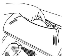
5. Para comenzar el proceso de vaciado, presione hacia abajo la tapa con ambas manos hasta que se inicie el motor. Continúe manteniendo la tapa cerrada. Cuando se encienda el indicador luminoso "sin manos", tenga la precaución de retirar las manos de la tapa. La unidad continuará con el vaciado y, a continuación, sellará la bolsa.
